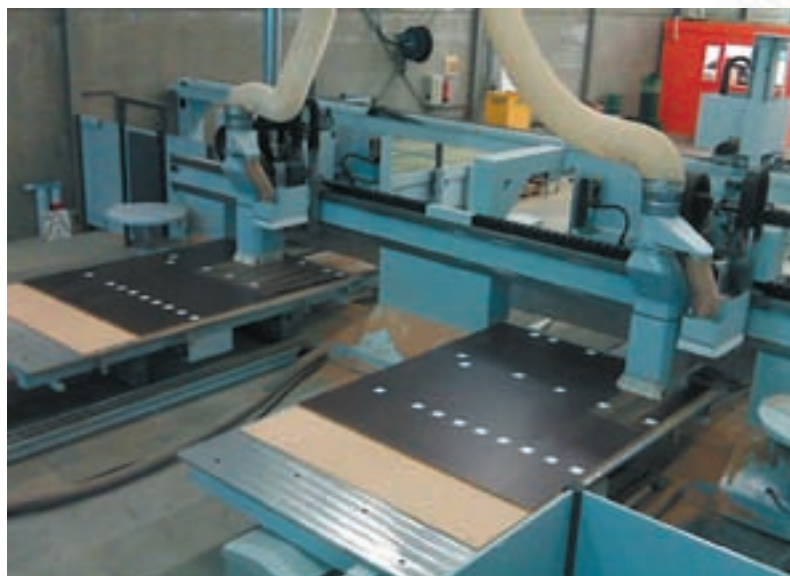
Обрабатывающий центр Homag BOF 612 с двумя независимыми загрузочными столами во время обработки предварительно этикетированных крупноформатных плит
