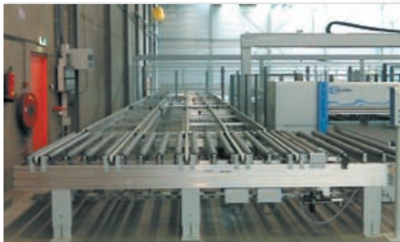
Путь отвода плит из раскройного центра HOLZMA на склад
