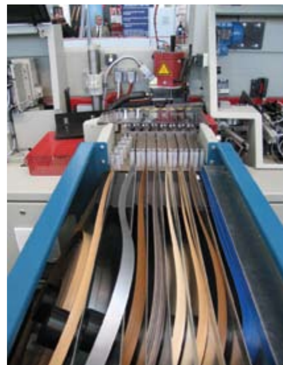
Станок может автоматически выбирать кромочный материал
