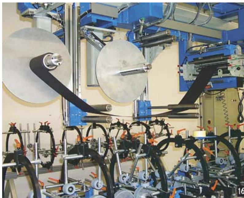
Двойное устройство для размотки плёнки
