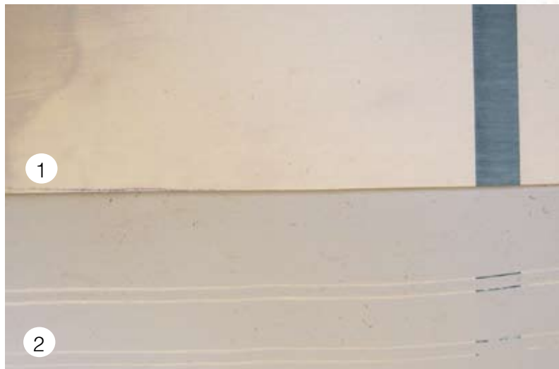
Рис. 4. Влияние толщины покрытия на укрывистость: 1 – толщина покрытия 5 мкм; 2 – толщина покрытия 20 мкм
