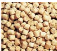
Полуфабрикат для экструзии или инъекционного формования – гранулы, содержащие древесину и термопластичный полимер
