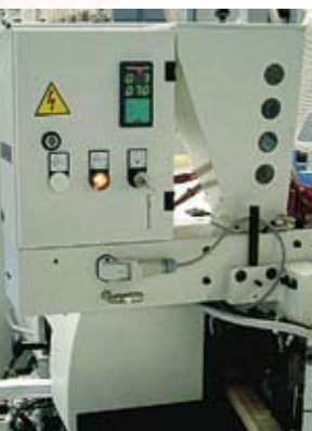
Клеевой узел. Устройство для разогрева клея.
